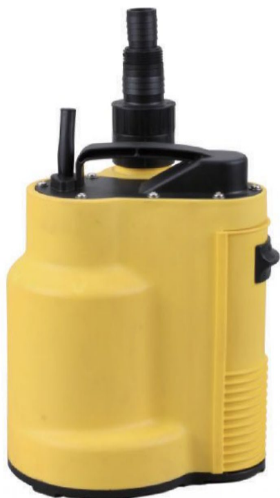
Pompa odwadniająca Aquaviva AV750CA (220 V, 12 m 3 /h, 0,75 kW) do czystej wody, z pływakiem
