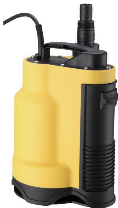
Pompa odwadniająca Aquaviva AV750DA (220 V, 13 m 3 /h, 0,75 kW) do brudnej wody, z pływakiem
