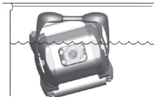
Nieprawidłowa wysokość linii wodnej
