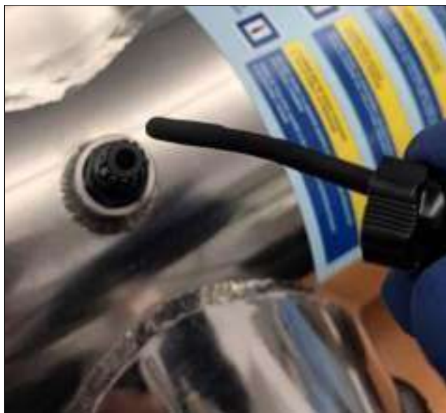
b) Najpierw włóż kabel do zaślepki, a następnie do wejścia kabla
