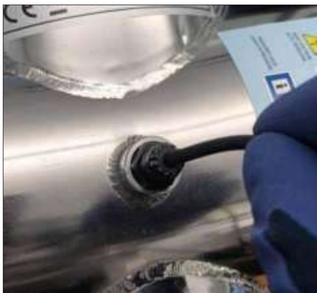
c) Upewnij się, że element czujnikowy (na końcu kabla) styka się z dolną częścią tulei
