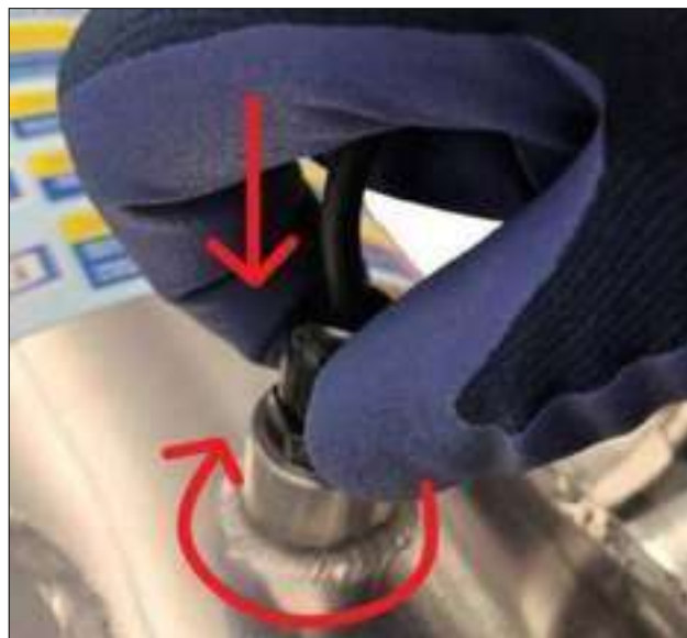
d) Zakręcić nakrętkę, dociskając kabel do spodu przelotki.
